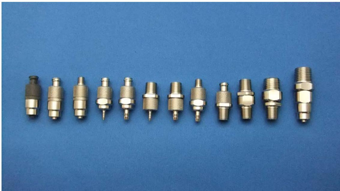
液だれや漏れを防止するため、シリンジ（バレル）の先端やポンプやチューブなどに接続しノズル（ニードル）をセットして使用するバルブです。バルブ内部のスプリング圧によって液材料の液だれや漏れを防止します。
